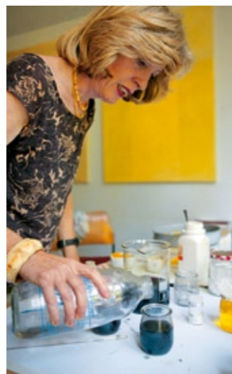
ZUGABE: Metallsalze und Alaunlösung lassen die Farbe in Flocken ausfallen.
