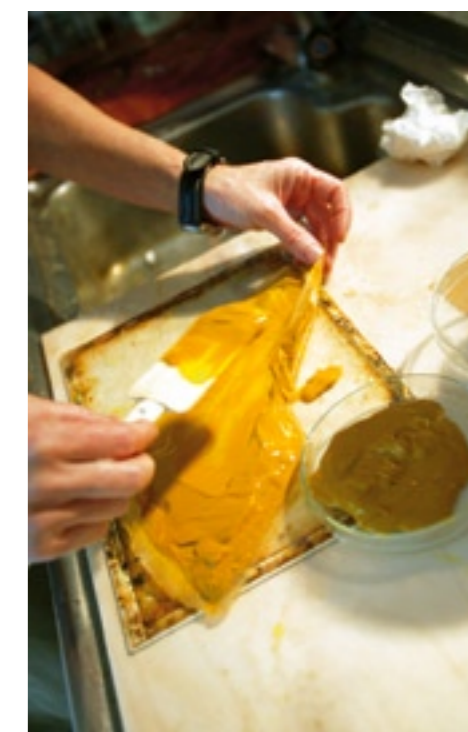
ERGEBNIS: Vom Filterpapier geschabt, landet die Farbpaste in Glasbehältern.
